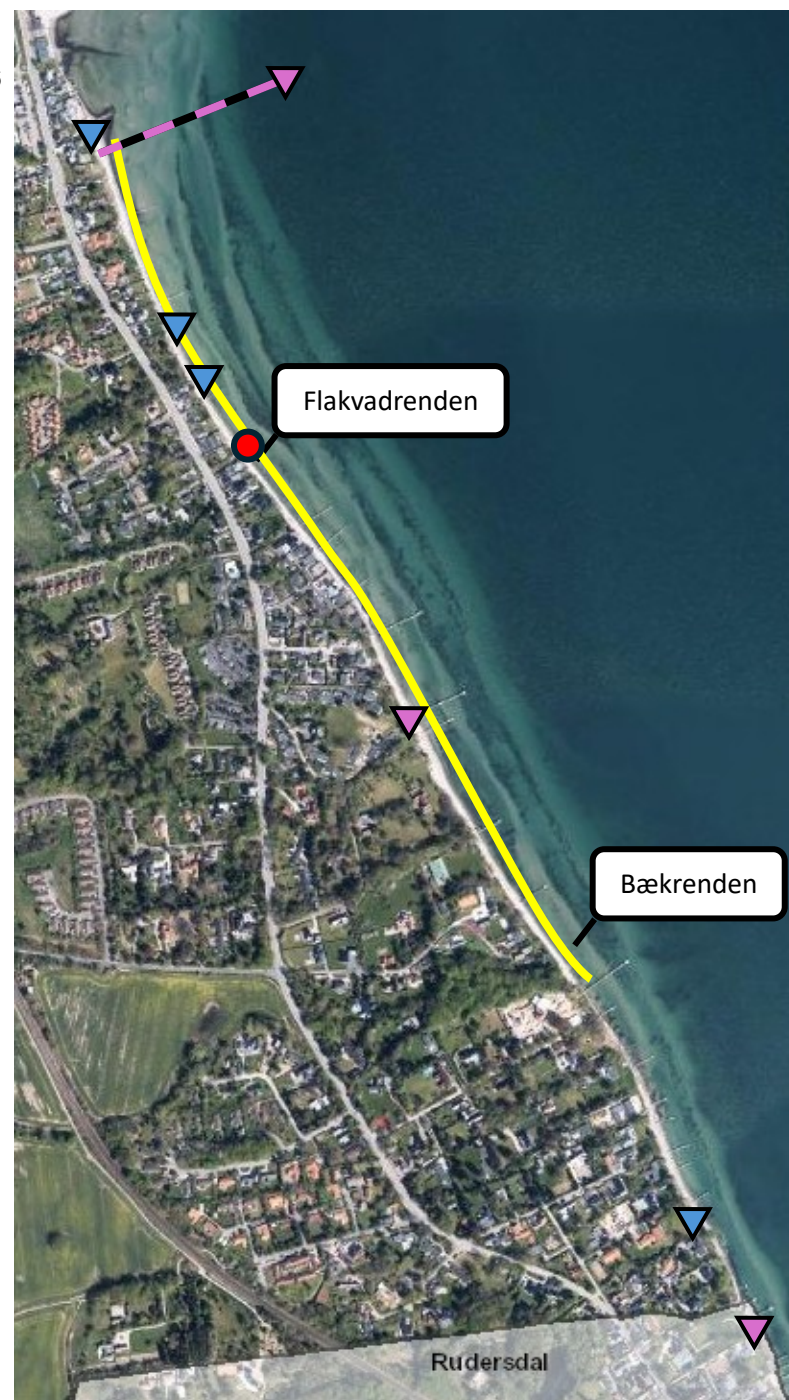
Røde cirkler viser kontrolovervågningssteder syd for Rungsted Badestrand. Farvede trekanter viser placering af udløbspunkter fra regnvandsledninger (blå) og fælles kloak (lilla). Strandene er vist med gul linje. Alle placeringer er vejledende.
